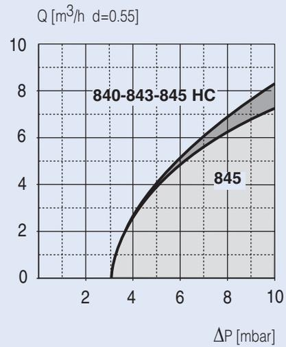
Freier Durchfluß bei  $\Delta p = 5 \text{ mbar } \Delta p$
