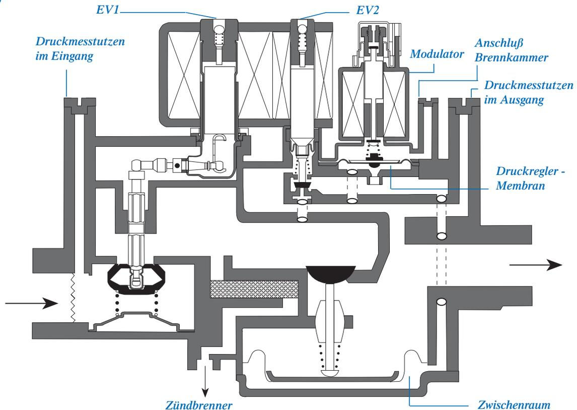
Das Mehrfachstellgerät der Serie 840-845 Sigma verfügt über 2 Sicherheitsmagnetventile.
