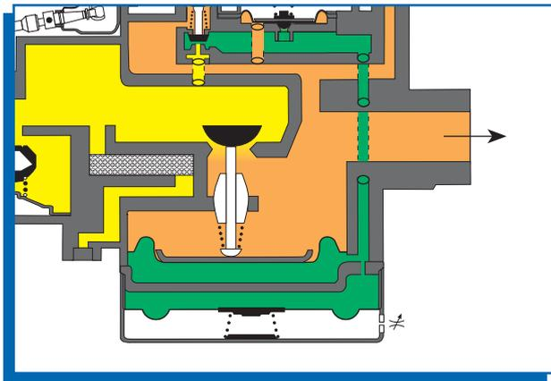
Wenn EV2 elektrisch versorgt wird, fließt das Gas in die Kammer der Langsamzündung. Der Gasdruck in der Zwischenkammer bewegt den Schieber, der teilweise den Gasweg öffnet. Der Ausgangsdruck bleibt während der Füllung der Zusatzkammer auf dem reduzierten Niveau.
