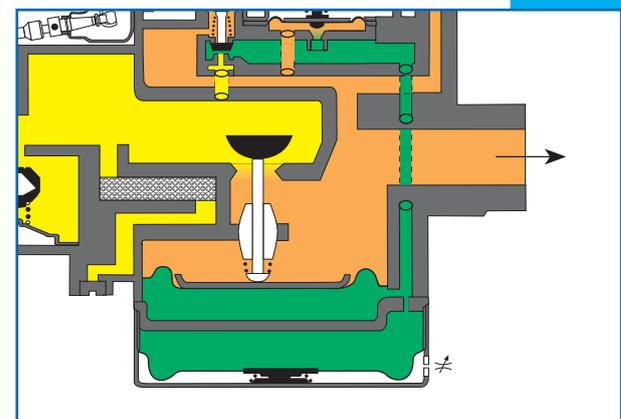
Wenn die Kammer der Langsamzündung komplett gefüllt ist, erhöht sich der Druck der Zwischenkammer und löst die vollständige Öffnung des Servoschiebers aus.
